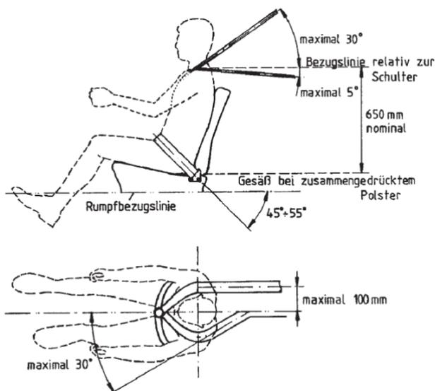
1. Wenn sich zwischen dem Befestigungspunkt für die Schultergurte und der Oberkante der Rückenlehne mehr als 152 mm Gurtband befinden, müssen geeignete Einrichtungen, z. B.
