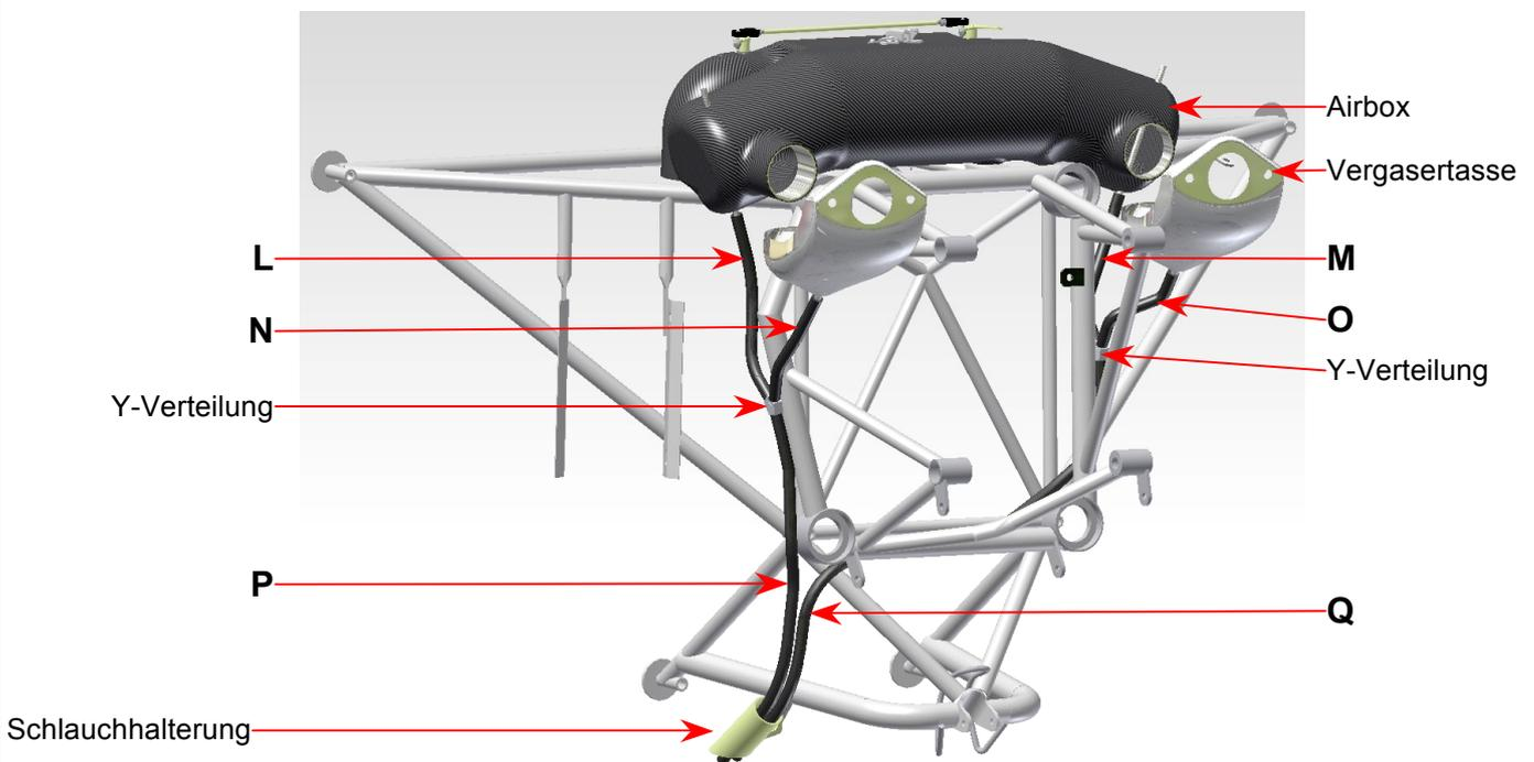
*Fig. 2 Lösen der Schläuche – Rotax 912, Einziehfahrwerk*
